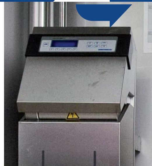
↑ MIII 제어 장치 우유 온도, 날짜 및 시간과 전체 시스템 상태 정보를 보여주는 대형 디스플레이.
